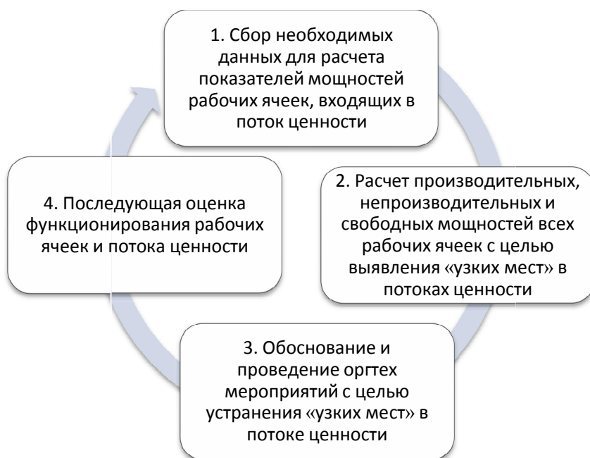
Рис. 2. Предлагаемый циклический алгоритм анализа производственных мощностей в системе управленческого учета
