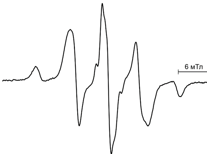
Рисунок 43. Спектр ЭПР соединения 15 в 2-Ме-ТГФ (130 К).
