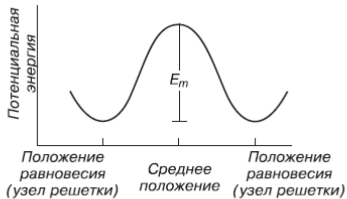
Рис. 6. Зависимость потенциальной энергии диффундирующего атома от его расположения [35]
