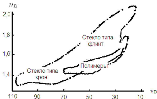
Рисунок 18. Диаграмма Аббе для оптических полимеров
