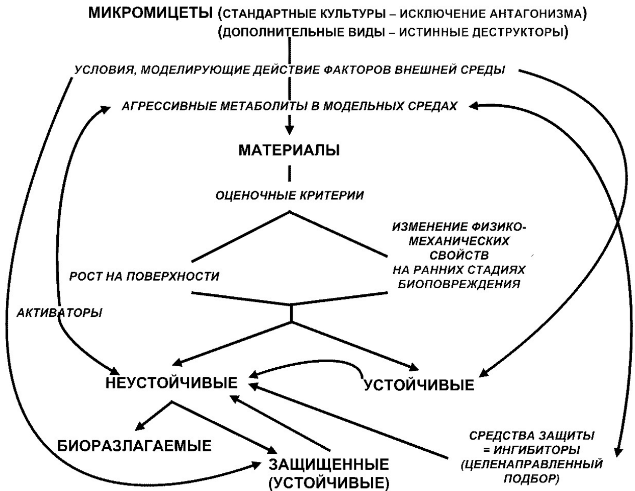
Рис. 3.46. Модифицированная схема оценки устойчивости промышленных материалов к биоповреждениям, учитывающая влияние экологических факторов на процессы микодеструкции
