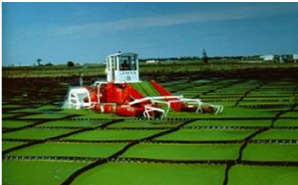
Рисунок 1.1 – Комбайн для сбора биомассы в очистных прудах, основанных на использовании ряски [18]
