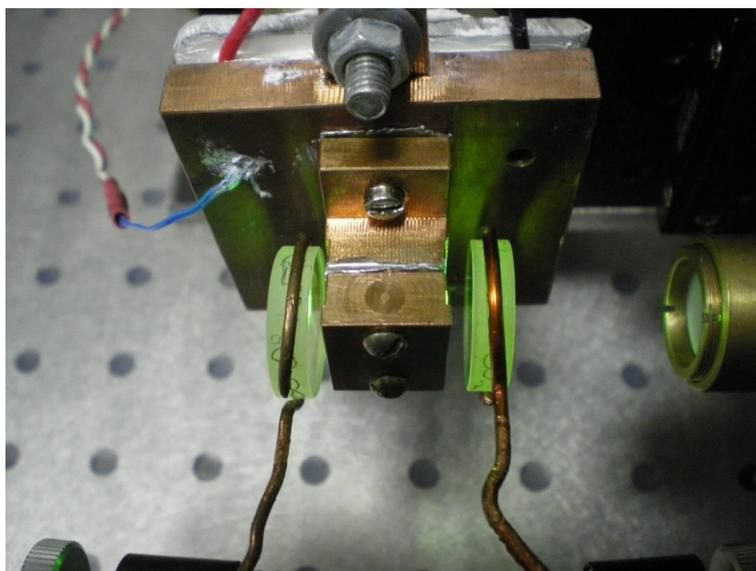
Рисунок 3.8 – Фотография фрагмента экспериментального стенда, включающего активный элемент из  $Y_2O_3:Er$  ( $n_{Er}=0.5$  ат.%), размещенного в медной оправке, резонатор лазера и объектив, фокусирующий излучение накачки в активный элемент
