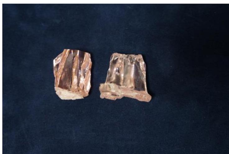
Рисунок 2.14 – Фотографии кристаллов  $ZrO_2$ -13,8мол.% $Y_2O_3$ -0,2мол.% $Er_2O_3$
