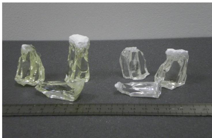
Рисунок 2.13 – Фотографии кристаллов  $ZrO_2$ -13,8 мол.% $Y_2O_3$ -0,2мол.% $Tm_2O_3$  и  $ZrO_2$ -14мол.% $Y_2O_3$ -2мол.% $Tm_2O_3$
