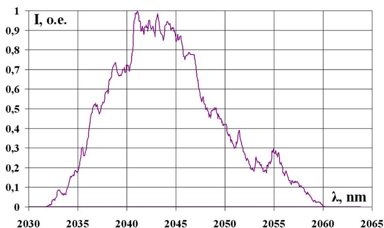
Рисунок 4.30 – Спектр лазерной генерации на переходе  ${}^3F_4 \rightarrow {}^3H_6$  ионов  $Tm^{3+}$  в кристаллах  $ZrO_2-12\text{мол.}\%Y_2O_3-2\text{мол.}\%Tm_2O_3$
