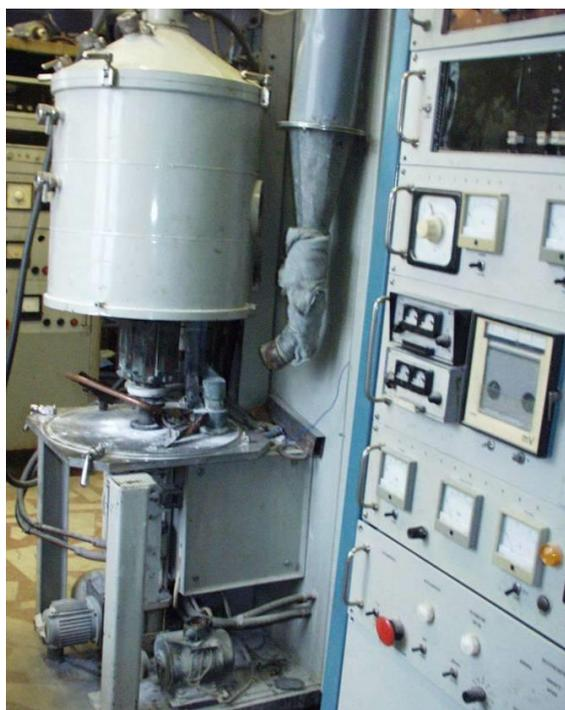
Рисунок 2.12 – Установка для прямого высокочастотного плавления диэлектриков в холодном контейнере «Кристалл-407» (частота 5.28 МГц, мощность 60 кВт)
