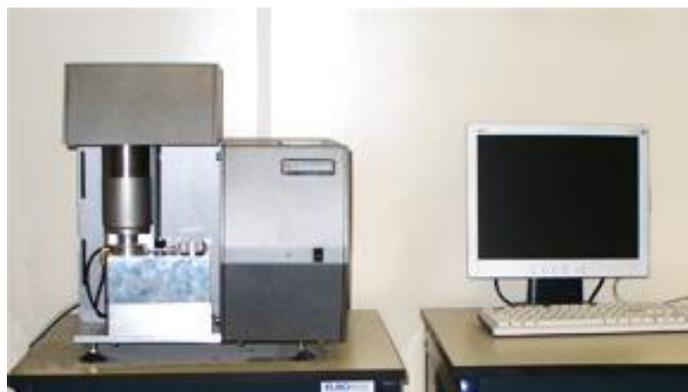
Рис. П.6. Дифференциальный сканирующий калориметр LABSYS фирмы SETARAM
