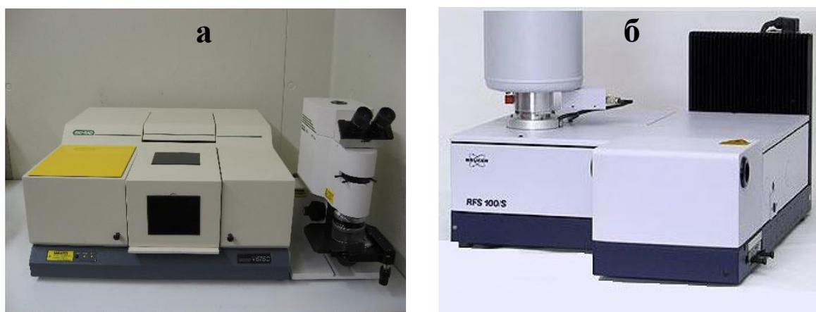
Рис. II.9. ИК-фурье- спектрометр 575C FTIR фирмы Bio-rad (а) и КР-спектрометр RFS 100/S фирмы Bruker (б)
