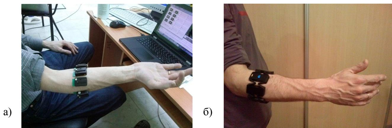
Рисунок 25 – Расположение электродов Trigno (а) и МУО (б) на предплечье для детектирования ЭМГ паттернов, соответствующих жестам кисти руки.
