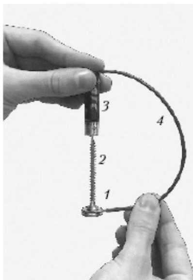
Рис. 38. Модель униполярного двигателя
