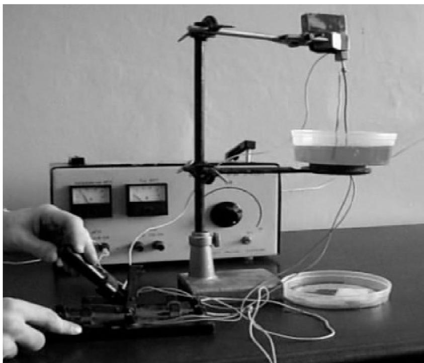
Рис. 39. Экспериментальная установка униполярного двигателя
