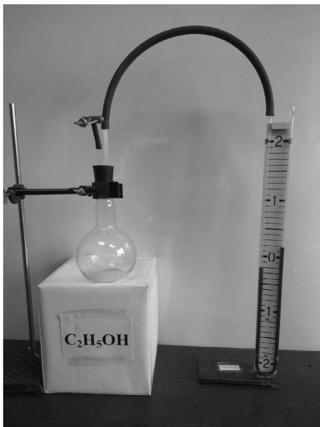
Рис. 19. Разность давлений в жидкостном манометре при добавлении второй порции этанола
