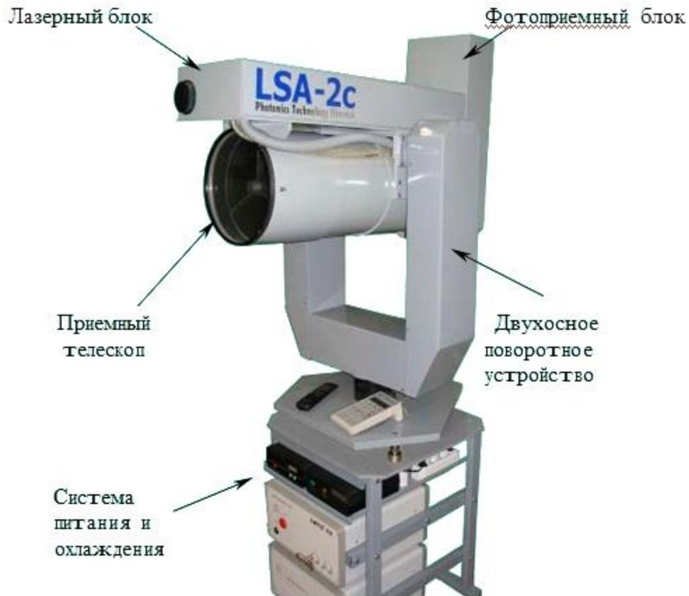
**Рисунок 2.1.** Принципиальная схема лидара.
