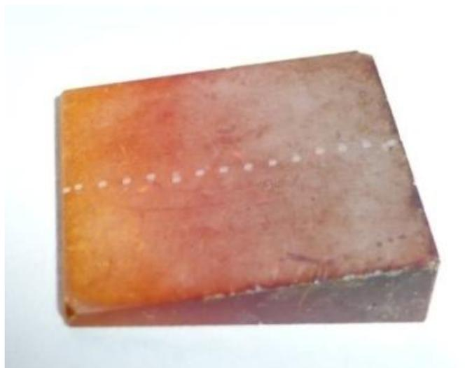
**Рис. 24.** Фото образца клиновидной формы, исследуемого методом ВИМС.
