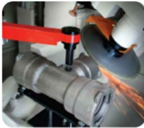
Рисунок 27. Процесс зачистки поверхности отливок
