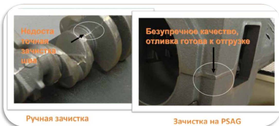
Рисунок 26. Точность зачистки при использовании нового оборудования
