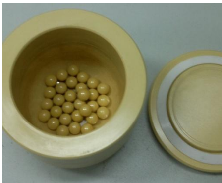
Рисунок 33 – Размольный стакан и мелющие тела из стабилизированного оксида циркония (Fritsch)
