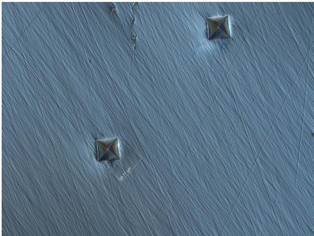
Рисунок 4.2 - Изображение поверхности кристалла 1Y-1.8NdSZ с отпечатками индентора при нагрузке 2кг, полученные с использованием ДИК
