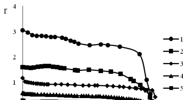
Рис.79. Зависимость наблюдаемой скорости реакции жидкофазной гидрогенизации ДЭМК \Gamma , \text{см}^3(\text{H}_2) \cdot (\text{с} \cdot \text{г}(\text{Ni}))^{-1} от степени превращения \alpha , ммоль( \text{Na}_2\text{S} )/г( \text{Ni} ) в воде на образцах катализатора с концентрацией: 1 – 0; 2 – 0.050; 3 – 0.100; 4 – 0.150; 5 – 0.200. Условия проведения гидрирования: T = 30^\circ\text{C} ; m_{\text{кат}} = 2,5 г, количество восстановленного металла ( \text{Ni} ) – 9%.
