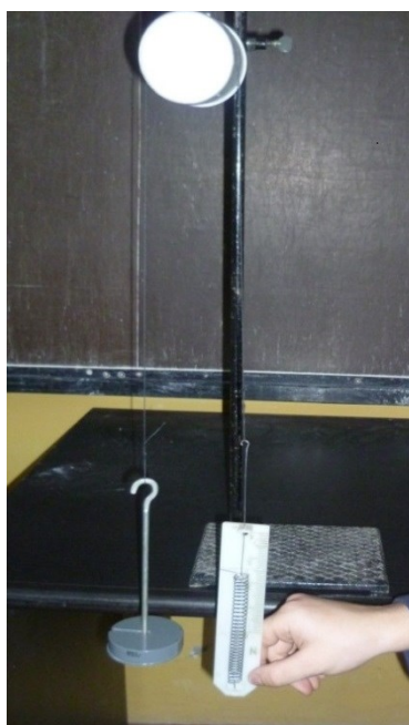
Рис. 27. Экспериментальная установка для исследования трения нити о неподвижный цилиндр
