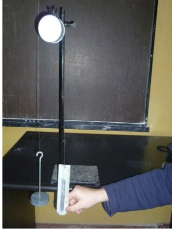
Рис.6. Вид установки при углах обхвата \pi , 3\pi , 5\pi
