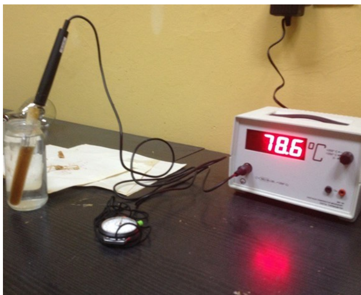
Рис. 33. Экспериментальная установка для изучения тепловых свойств парафина и воска
