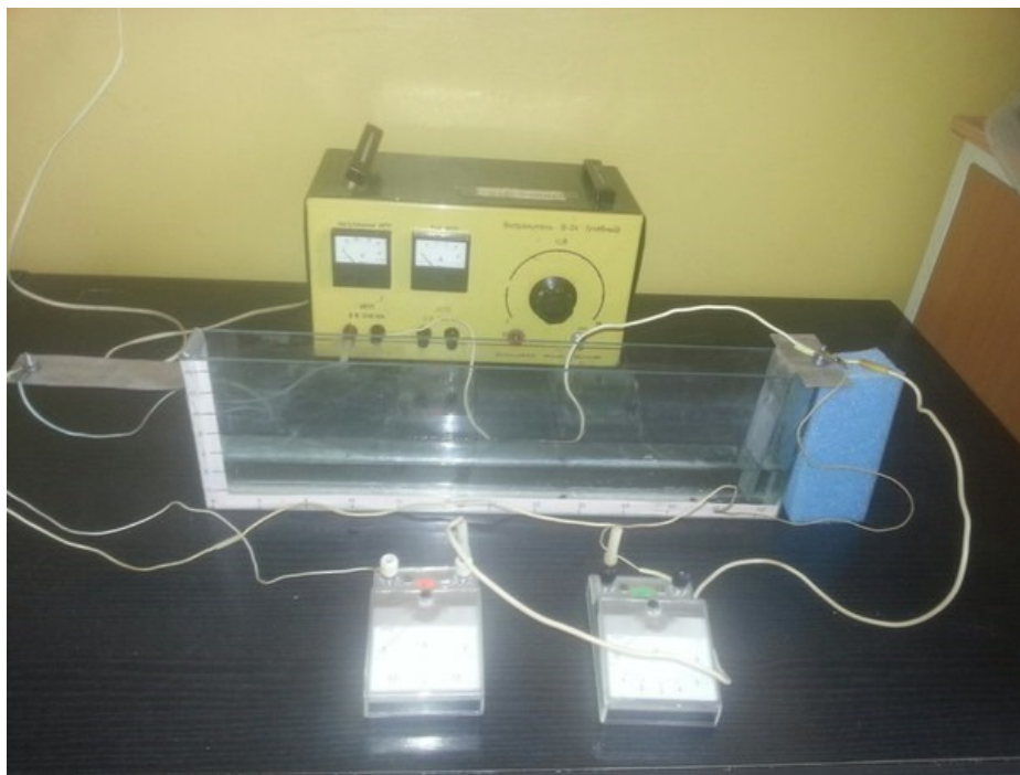
Рис. 36. Установка для изучения протекания тока в электролите
