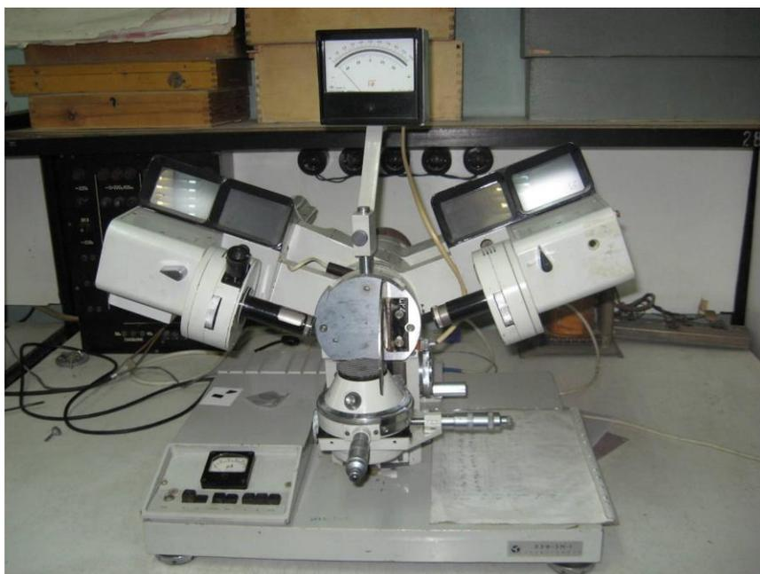
**Рис. 2.5.** Внешний вид эллипсометра ЛЭФ-3М-1
