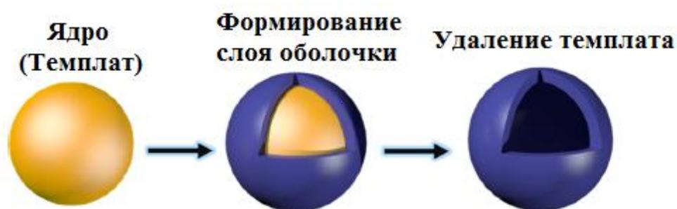
**Рис. 1.10.** Схема синтеза частиц типа «ядро-оболочка»
