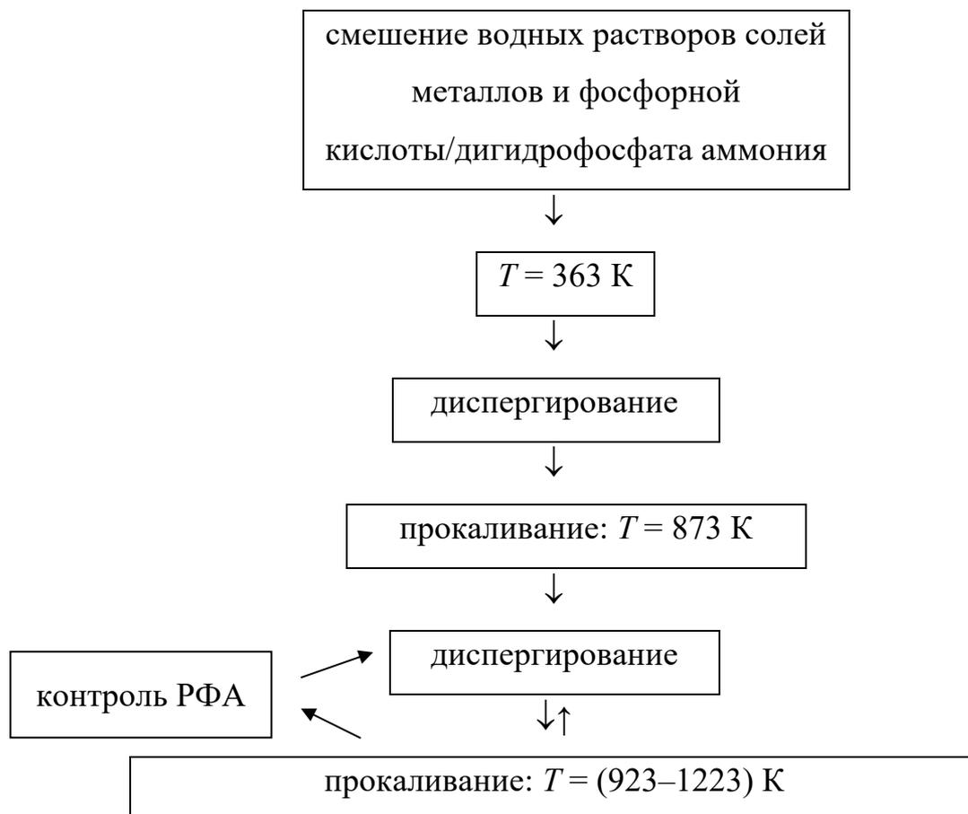
К стехиометрической смеси водных растворов солей металлов медленно при перемешивании добавляли раствор фосфорной кислоты или дигидрофосфата аммония, взятый также в соответствии со стехиометрией фосфата. Выпавший осадок сушили при  $T = 363 \text{ K}$ , затем диспергировали в ступке и подвергали ступенчатому отжигу при температурах  $T = (923-1223) \text{ K}$ . Отжиг чередовали с диспергированием после каждой стадии.
