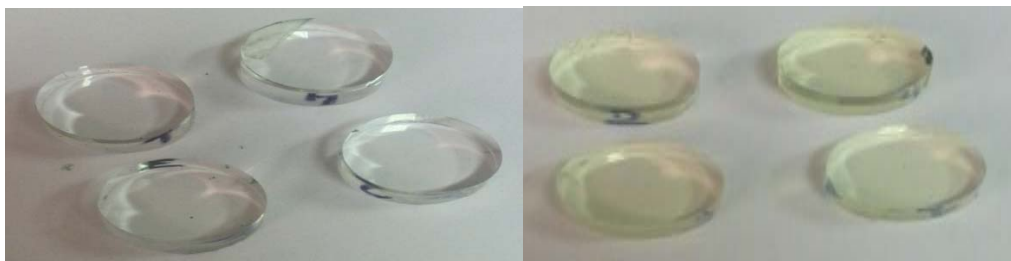
Рис. 7. Образцы таблеток ПММА, содержащего 5% дикротоната трифенилсурьмы (слева) и 5% дикротоната трифенилвисмута (справа)
