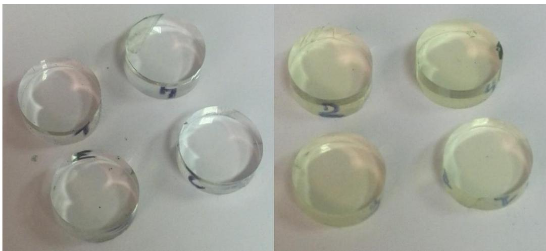
**Рисунок 29** - Образцы полиметилметакрилата, содержащие по 5% масс. дикротоната трифенилсурьмы **I** (слева) и дикротоната трифенилвисмута **VIII** (справа)
