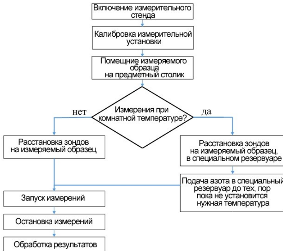
Рис. 4.2.2. Блок-схема проведения измерений ВФХ при комнатной температуре и при отрицательной температуре [А2]
