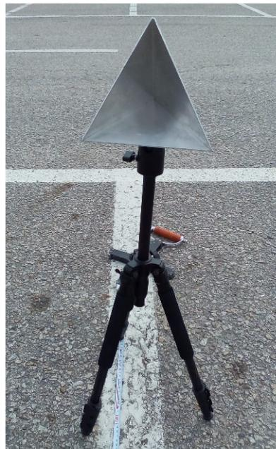
Рисунок 3.7 Уголкового отражатель
