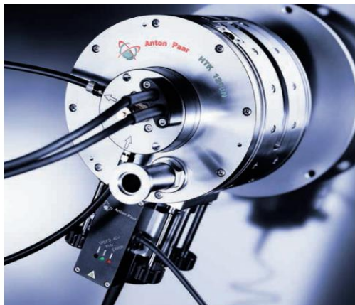
Рисунок II. 4 Высокотемпературная приставка Anton Paar НТК 1200
