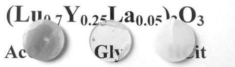
**Рис. 9. Внешний вид керамик  $(\text{Lu}_{0.7}\text{Y}_{0.25}\text{La}_{0.05})_2\text{O}_3$ , полученных с использованием порошков, синтезированных из различных прекурсоров**
