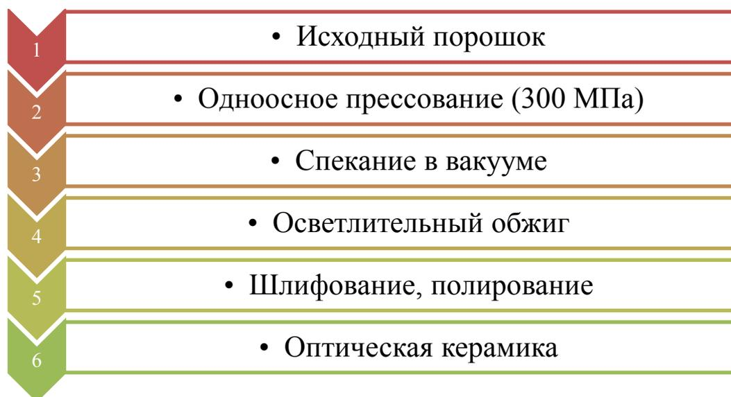
**Рис. 17. Блок-схема процесса получения керамики  $\text{Lu}_2\text{O}_3$**
