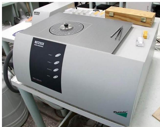
Рисунок 2.1 - Внешний вид калориметра DSC 204 F1 Phoenix (NETZSCH, Германия)
