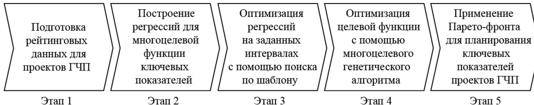
Рисунок 16. Планирование оптимальных значений ключевых показателей проектов ГЧП с помощью метода MGA.
