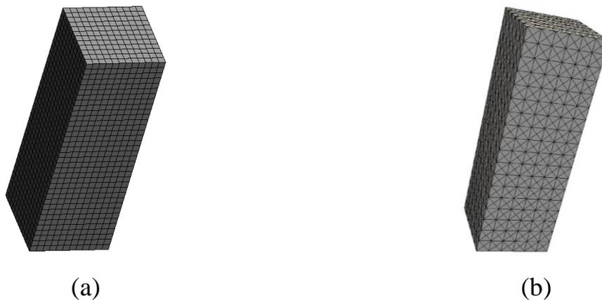
Рис. 3.18 Гранично-элементные сетки для задачи о действии на грузки на призматическое тело: (a) – сетка из четырехугольных элементов, (b) – сетка из работы [231]
