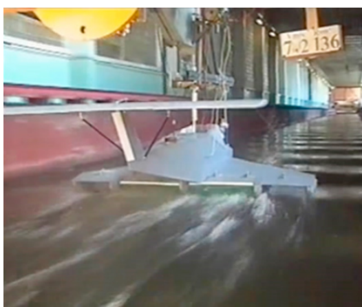
Рисунок 4.2 – Буксируемая модель АСВП с аэродинамической разгрузкой
