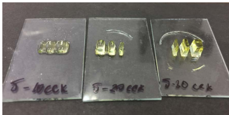
Рис. 30. Фотографии образцов, изготовленных при различном времени экспонирования через маску, приведённую на рисунке 28 (б).
