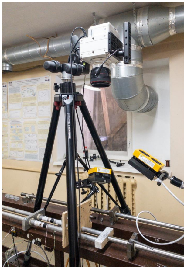
Рисунок3. Видеорегистрация процесса динамического изгиба балки
