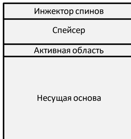
Рисунок 1.3. Функциональная схема полупроводниковой структуры, в которой в результате спиновой инжекции реализуется эмиссия циркулярно-поляризованного света.
