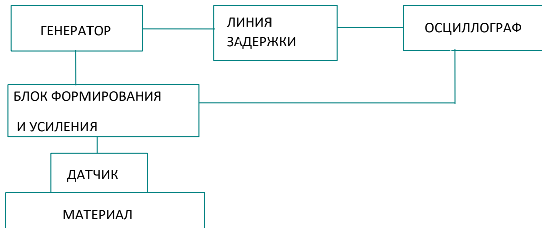
Рис. 4.1. Блок-схема экспериментальной установки.
