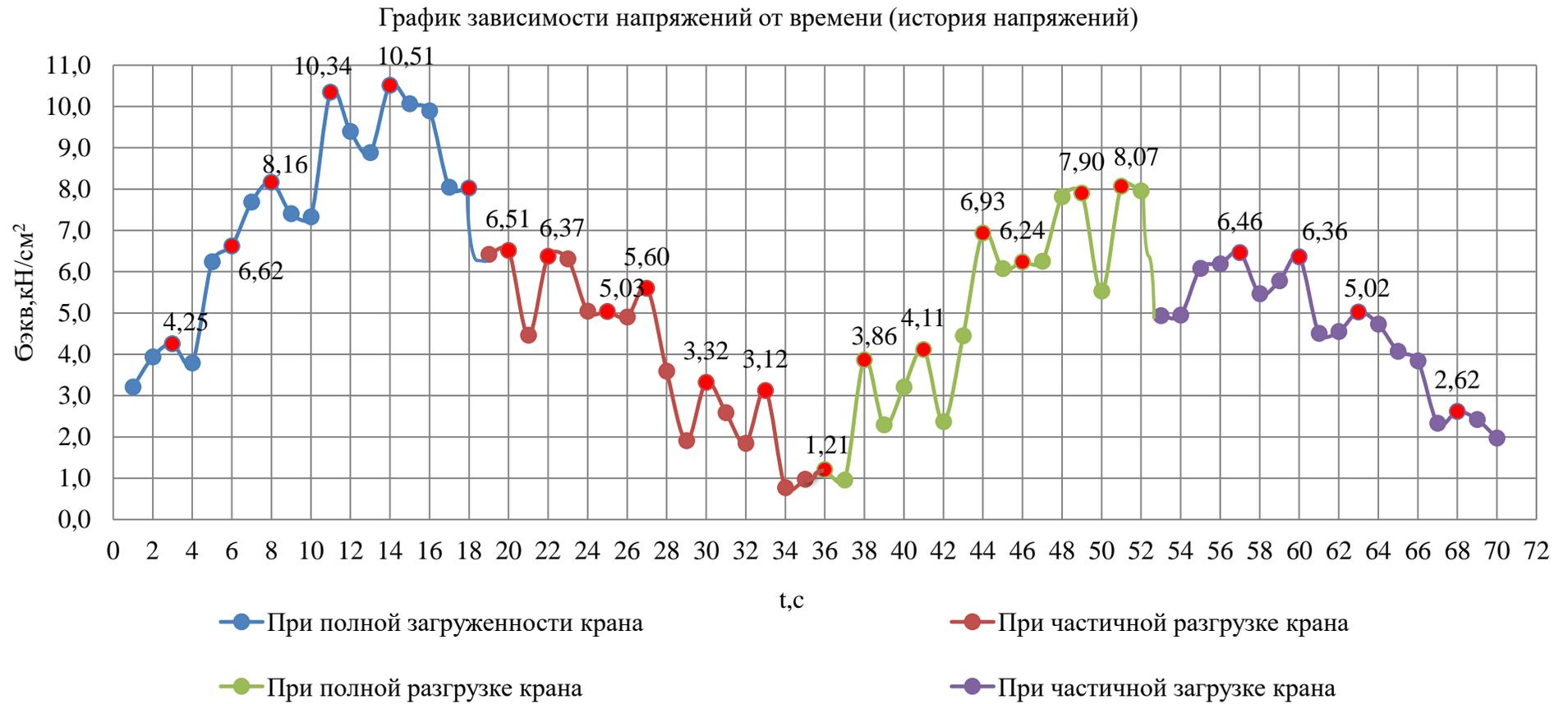
Рис. 1.3. График зависимости напряжений от времени в процессе работы литейного крана (история напряжений)
