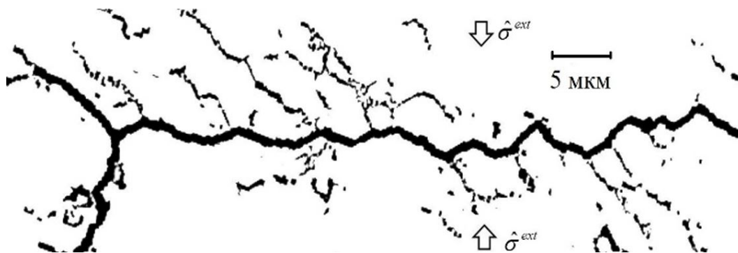
Рисунок 7 — EBSD карты, иллюстрирующие фрагментированную структуру деформированного поликристалла альфа-железа одноосное сжатие, \varepsilon_{pl} = 1 , скорость деформации 10 \text{ с}^{-1} , при 400^\circ\text{C}
