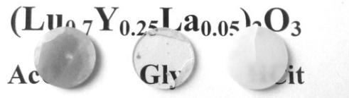
**Рис. 7. Внешний вид керамик  $(\text{Lu}_{0.7}\text{Y}_{0.25}\text{La}_{0.05})_2\text{O}_3$ , полученных с использованием порошков, синтезированных из различных прекурсоров**
