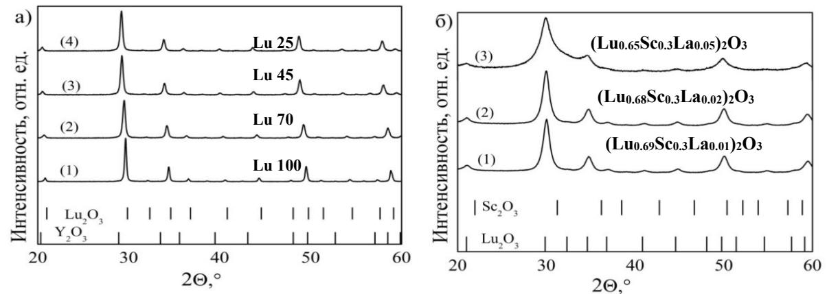
**Рис. 5. Дифрактограммы порошков (а)  $(\text{Lu}_y\text{Y}_{0.95-y}\text{La}_{0.05})_2\text{O}_3$ , (б)  $(\text{Lu}_{0.7-z}\text{Sc}_{0.3}\text{La}_z)_2\text{O}_3$**
