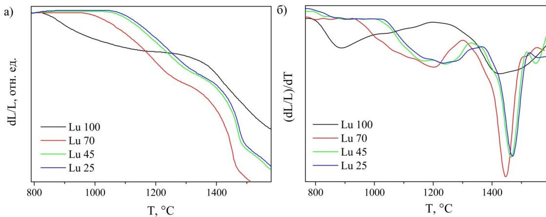
**Рис. 12. Усадка (а) и скорость усадки (б) керамики оксида лютеция и твёрдых растворов оксидов лютеция-иттерия-лантана**
