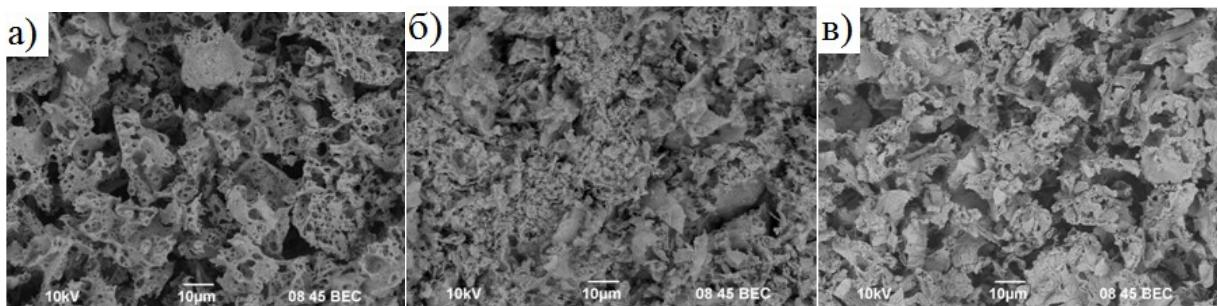
**Рис. 3. Микроснимки порошков  $\text{Lu}_2\text{O}_3$  (а) Gly, (б) AcO, (в) HCit**
