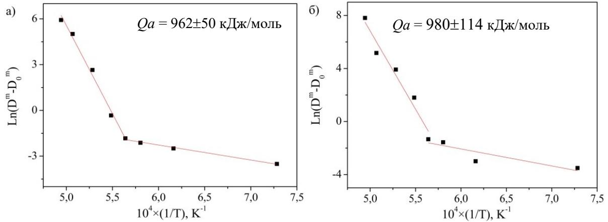
**Рис. 11. Зависимость  $\ln[(D''(t) - D''(t_0))]$  керамик оксида лютения и твёрдых растворов оксидов иттрия-лютеция-лантана от обратной температуры: Lu100 (а), Lu70 (б)**
