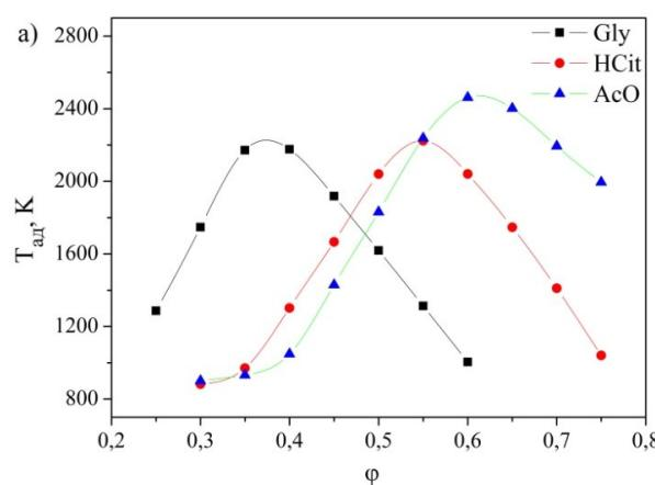
**Рис. 1. Адиабатическая температура горения смесей  $\varphi\text{Lu}(\text{NO}_3)_3-(1-\varphi)\text{NH}_2\text{CH}_2\text{COOH}$  (Gly),  $\varphi\text{Lu}(\text{NO}_3)_3-(1-\varphi)\text{C}_6\text{H}_8\text{O}_7$  (HCit),  $\varphi\text{Lu}(\text{NO}_3)_3-(1-\varphi)\text{Lu}(\text{CH}_3\text{COO})_3$  (AcO)**
