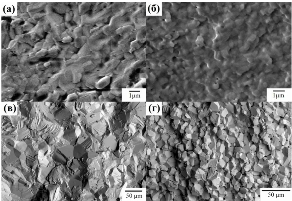
**Рис. 9. Микроснимки поверхностей излома керамики Lu70 (а,в) и Lu100 (б,г), полученных вакуумным спеканием при  $T = 1450$  °C и  $1750$  °C и времени выдержки 5 ч**
