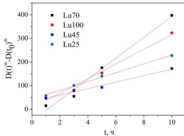
**Рис. 10. Зависимость среднего размера зерна керамик оксидов лютения-иттрия-лантана от времени выдержки при температуре 1700 °C: Lu70 (а), Lu100 (б), Lu45 (в) и Lu25 (г)**
