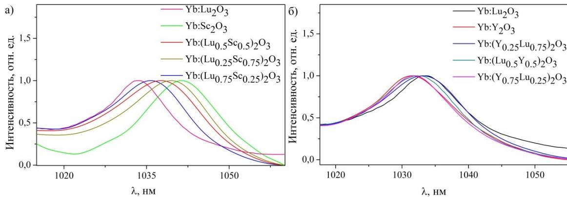
**Рис. 6. Область 1010–1060 нм спектра люминесценции порошков 5%Yb:(Sc<sub>x</sub>Lu<sub>1-x</sub>)<sub>2</sub>O<sub>3</sub> (а), 5%Yb:(Y<sub>x</sub>Lu<sub>1-x</sub>)<sub>2</sub>O<sub>3</sub> (б)**
