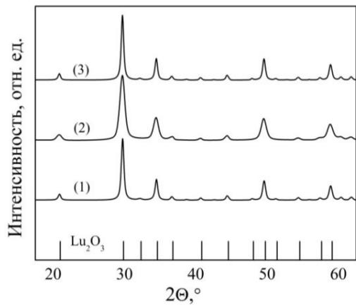
**Рис. 2. Дифрактограммы СВС-порошков  $\text{Lu}_2\text{O}_3$ , полученных из различных прекурсоров: (1)  $\text{Lu}_2\text{O}_3$  AcO, (2) HCit, (3) Gly**
