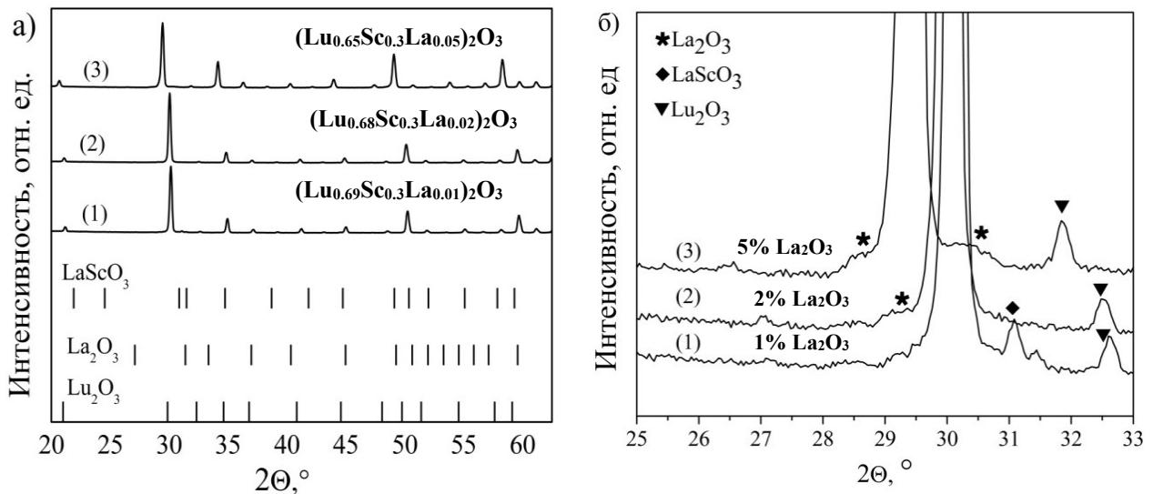
**Рис. 8. Дифрактограммы керамических образцов (а)  $(Lu_{0.7-z}Sc_{0.3}La_z)_2O_3$  и (б) область дифрактограммы  $2\Theta^\circ = 25-33$**
