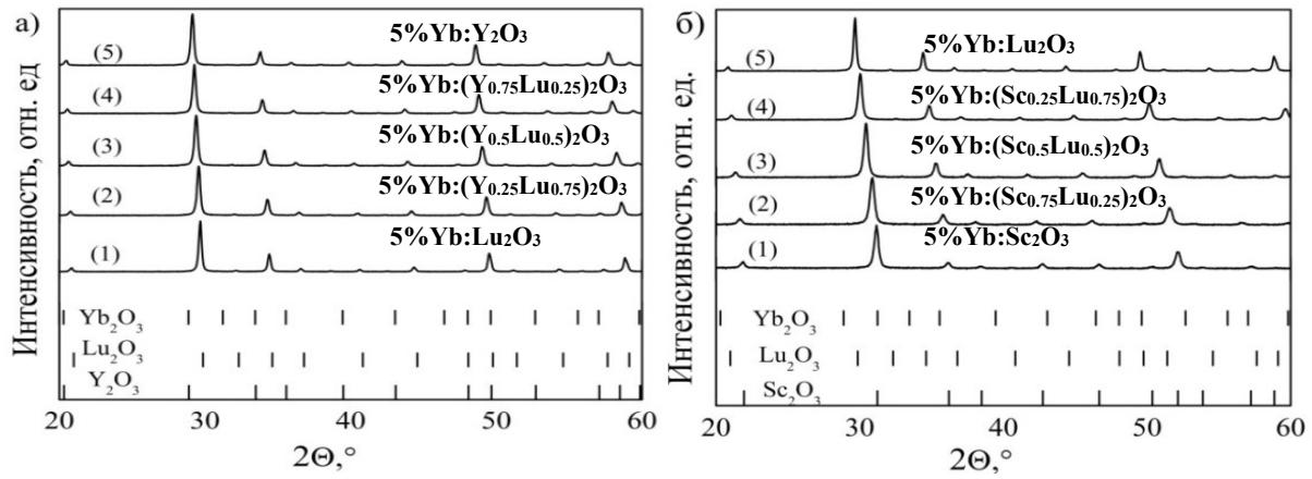
**Рис. 4. Дифрактограммы полученных СВС-порошков (а)  $\text{Yb}_{0.1}(\text{Y}_x\text{Lu}_{1-x})_{1.9}\text{O}_3$ , (б)  $\text{Yb}_{0.1}(\text{Sc}_x\text{Lu}_{1-x})_{1.9}\text{O}_3$**
