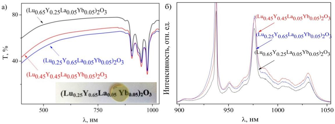
**Рис. 13. Спектр пропускания (а) и спектр люминесценции (б) керамики на основе твердых растворов 5%Yb:(Lu<sub>y</sub>Y<sub>0.95-y</sub>La<sub>0.05</sub>)<sub>2</sub>O<sub>3</sub>**
