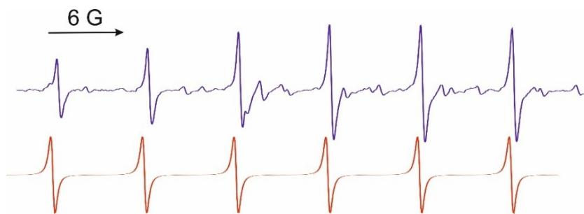
Рисунок 2.6.2. спектр семихинолята лития соединения **4**. Толуол, 293К (синий); симулированный (красный).  $g=2.0052$ ,  $a(\text{Mn})=7.3[\text{Гc}]$
