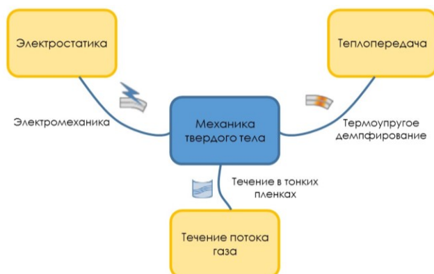
Рисунок 5 – Связанные физические эффекты при моделировании ЧЭ МЭМС-вакуумметра
