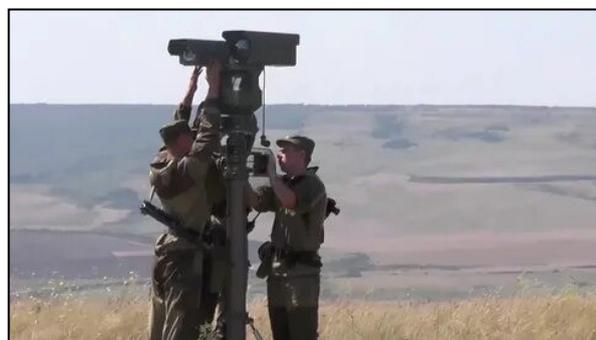
*Рис. 2.2. Автономный мобильный комплекс видео-тепловизионного наблюдения «Муром-П»*
