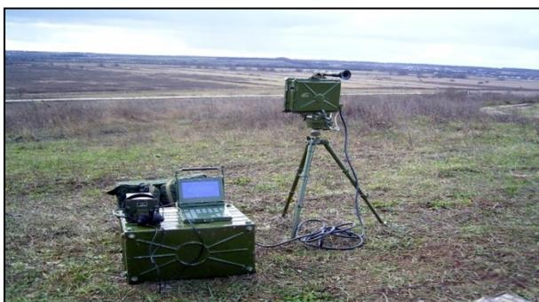
*Рис. 2.1. Портативная радиолокационная станция ближней разведки с панорамным индикатором «ФАР-ПВ»*
