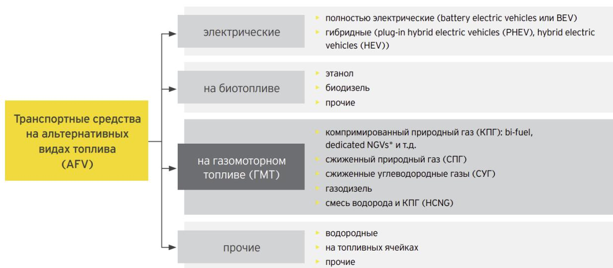
Рисунок 1.17. Транспортные средства на альтернативных видах топлива. Источник: Энергетический центр ЕУ по Центральной, Восточной и Юго-Восточной Европе и Центральной Азии. \*bi-fuel – автомобили на нескольких видах топлива, dedicated NGVs (natural gas vehicles) – автомобили, работающие только на природном газе
