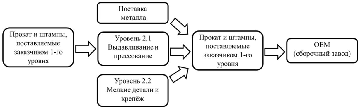
Рисунок 2.4. Пример 1 – Организация производства крупной детали кузова.
