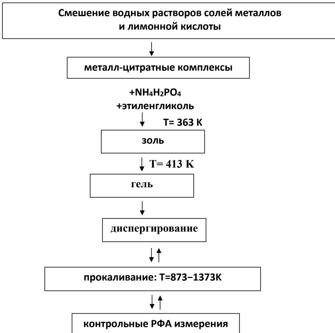
Рис. 2. Схема синтеза фосфатов методом Печини.
