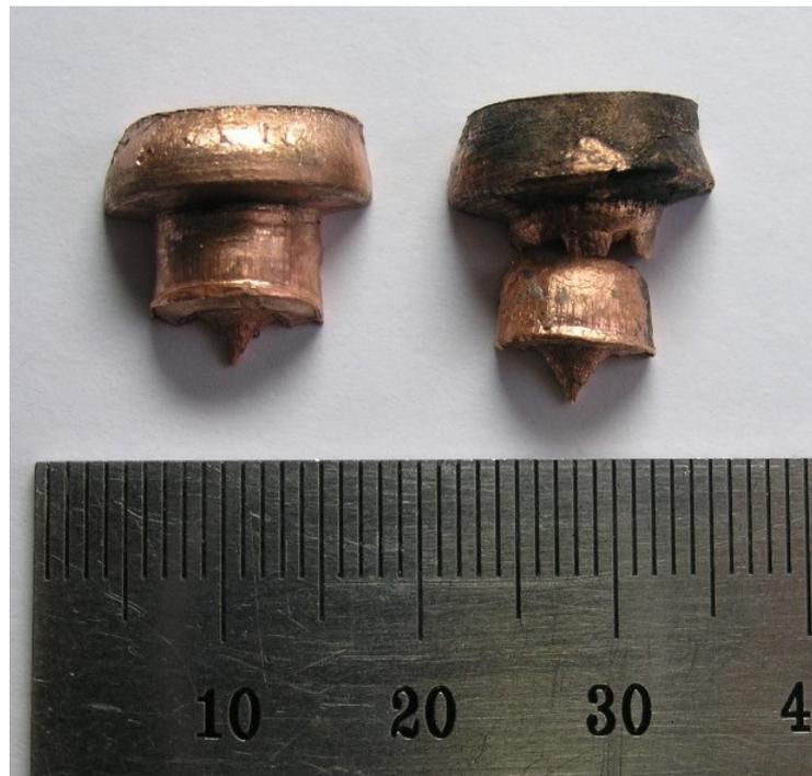
Рисунок 2.8 – Фотографии микрообразцов после динамических испытаний ОСФ. Слева – образец из меди марки М06, справа – образец из меди марки М00к
