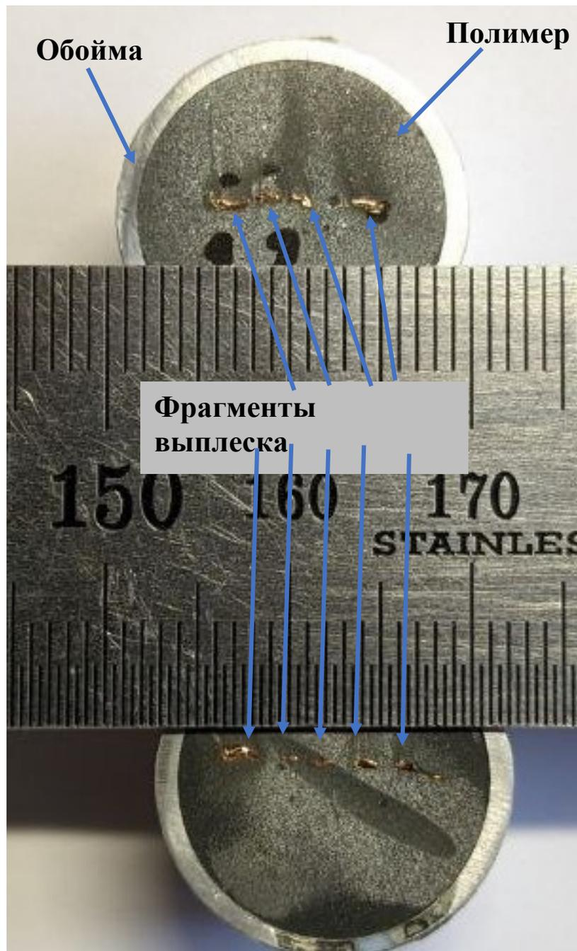
Рисунок 2.11 – Фрагменты выплеска для металлографических исследований
