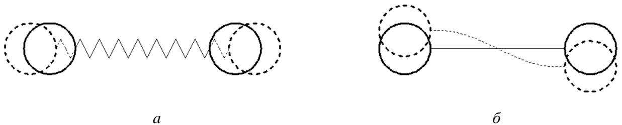
Рис. 3-25. Продольный (а) и поперечный (б) квадрупольный резонатор
