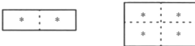
Рис. 1-4. Расположение резонаторов в поперечном сечении волновода
