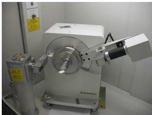
**Рисунок 11.** Гониометр дифрактометра Shimadzu XRD-6000
