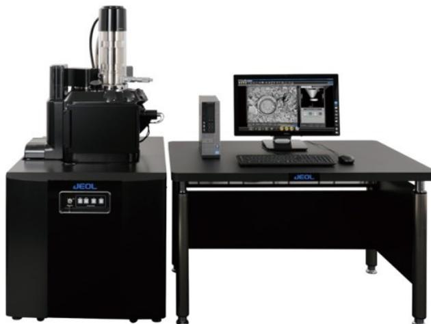
**Рисунок 13.** Сканирующий электронный микроскоп JEOL JSM-IT3000LV
