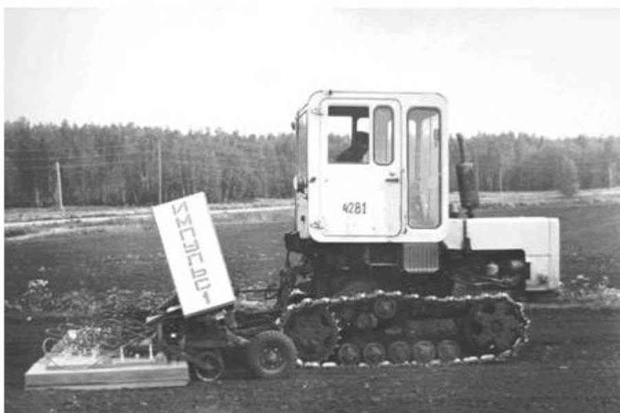
Рис. №60. Опытный образец трактора с навесным оборудованием СВЧ для борьбы с сорняками
