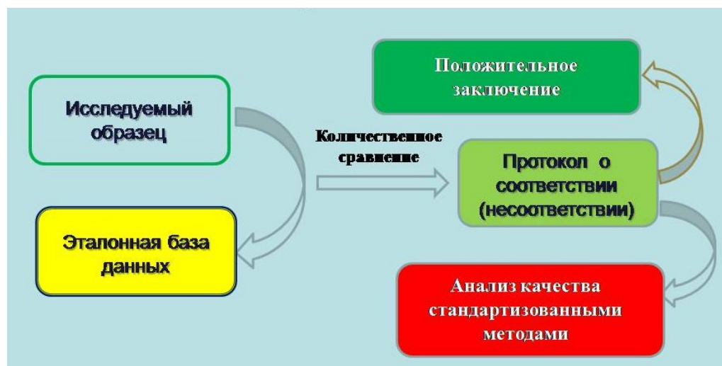
Рис. №21. Принцип метода экспресс-контроля многокомпонентных жидкостей.
