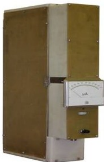
Рис. №85. Устройство «Садко» для предпосевной стимулирующей и обеззараживающей обработки семян в полевых работах подсолнечника и сафлора
