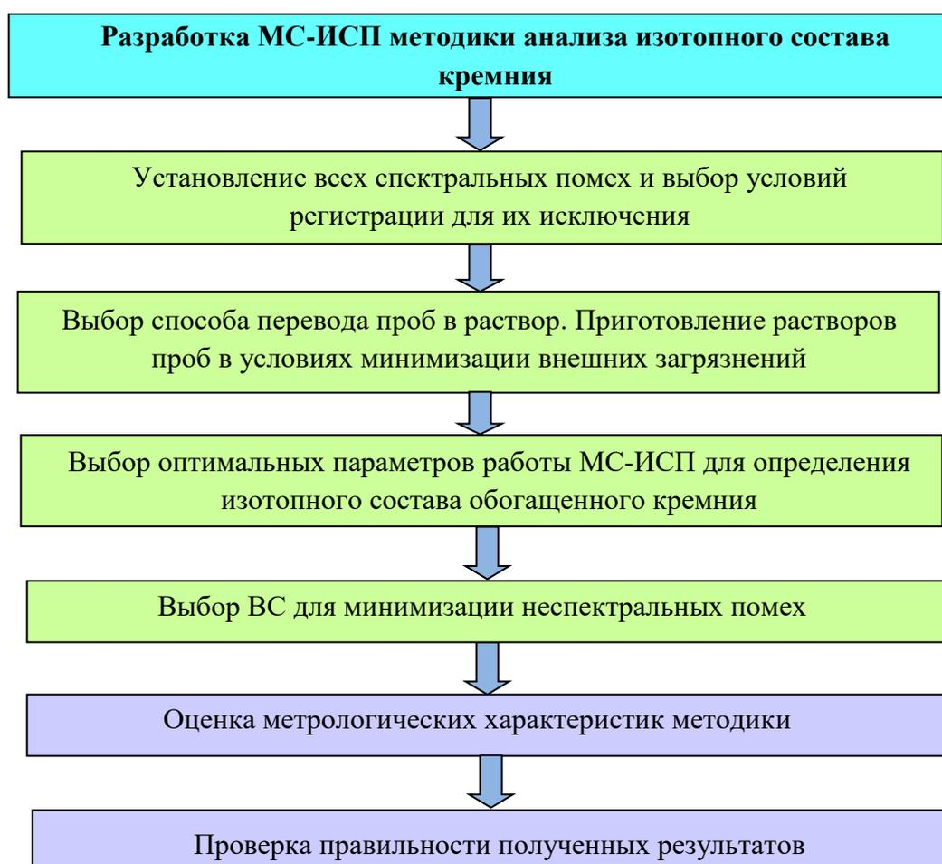
**Рисунок 2.1** - Схема общего методического подхода к МС-ИСП определению изотопного состава обогащенного кремния.
