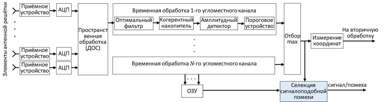
Рис. 2.1. Типовая структурная схема пространственно-временной обработки радиолокационных сигналов
