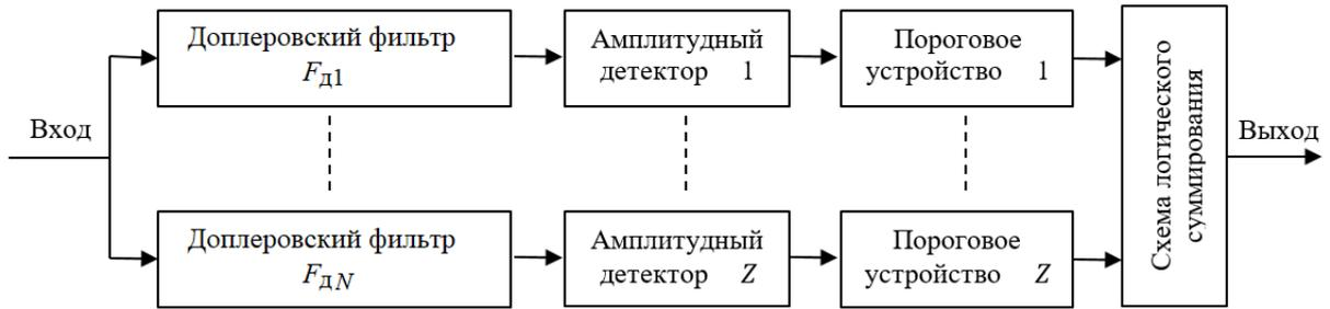
Рис. 2.22. Структурная схема когерентного накопителя азимутального пакета
