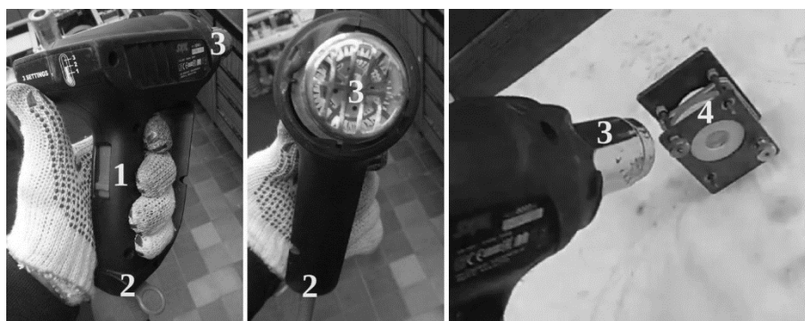
Рисунок 2.5 – Технический фен, использовавшийся в методике III, вид сбоку (а) и спереди (б), нагрев ячейки (в): 1 – регулировка включения и температуры воздуха обдува, 2 – шнур питания, 3 – диффузор (сопло), 4 – разборная ячейка в собранном виде
