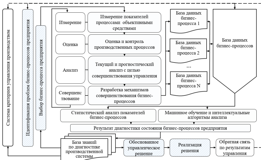
Рисунок 3. Схема модели диагностики производственных систем Источник: составлено автором
