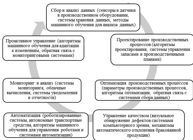
Рисунок 2. Процедура управления производственной системой на основе систем искусственного интеллекта
